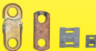
Collegamenti fusibili in rame, ottone e rivestiti dopo 300 ore di nebbia salina al 20%.
