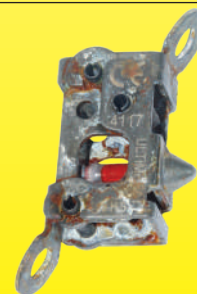
Meccanismo di rivelazione incendio in acciaio zincato dopo 240h in nebbia salina al 20%
