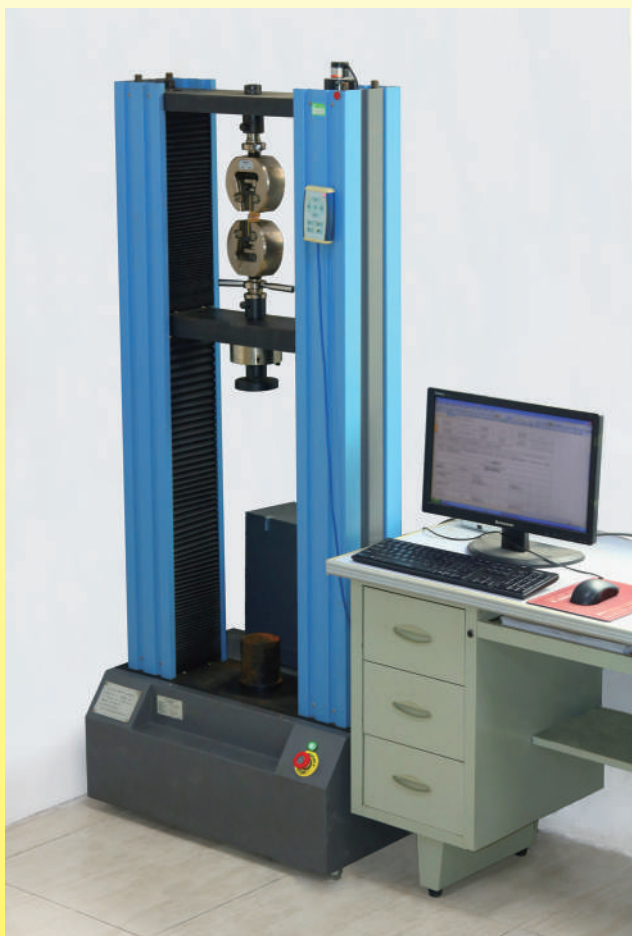
Resistenza alla trazione e allungamento a rottura
